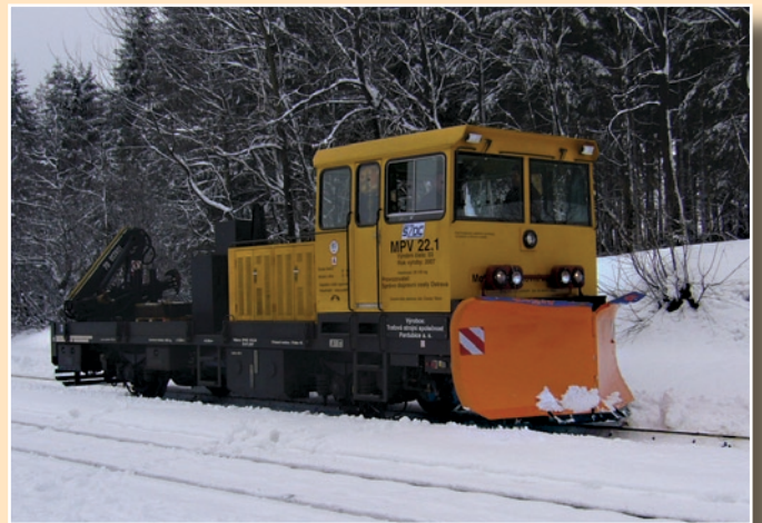
ČD VYUŽIVÁ NAŠICH RADLÍK K PROHRNOVÁNÍ KOLEJÍ
