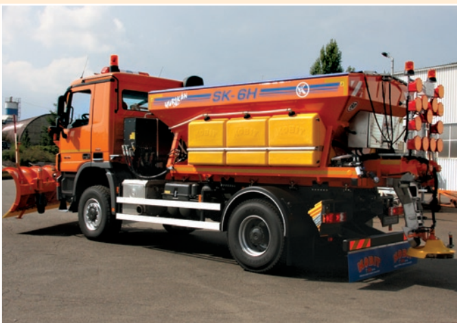
SYPAČ SYKO - NA BOKU ZÁSOBNÍKY NA SOLANKU
